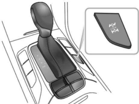
Presione el botón para ingresar al modo de bloqueo, luego el indicador ON del modo de bloqueo se ilumina en verde mientras la interfaz del instrumento muestra "4WD Lock On"; presione el botón nuevamente para ingresar al modo automático y el indicador se apagará.
