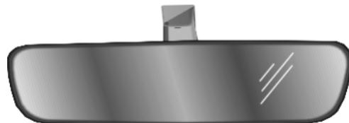
Cuando el botón START/STOP está en ON/RUNNING, la función antireflejante funciona automáticamente. Cuando se presenta un reflejo excesivo al conductor el sensor de luz activa la función antirreflejos.
