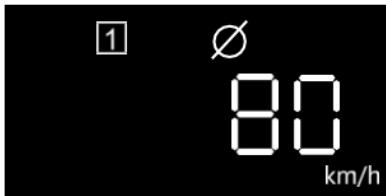
Muestra la velocidad promedio del vehículo, el valor se restablecerá después de mantener el vehículo apagado por un tiempo o por mantener presionado por algún tiempo el botón OK
