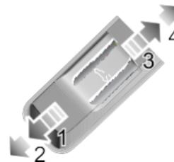
Empuje el botón del cristal del quemacocos hacia atrás hasta la 1<sup>a</sup> posición (3) y manténgalo pulsado, el quemacocos se abrirá manualmente. Puede detener el movimiento del quemacocos en cualquier momento soltando el botón. Empuje el botón del cristal hacia atrás con excesiva fuerza
