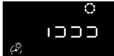
En la interfaz de ajuste del nivel de iluminación, presione el botón OK a la derecha del volante para ajustar el brillo de la luz de fondo. Hay en total 3 niveles de brillo.
