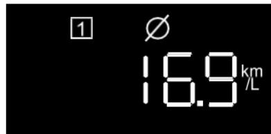
Muestra el consumo promedio de combustible, el valor se restablecerá automáticamente después de mantener el vehículo apagado por un tiempo o por mantener presionado por algún tiempo del botón OK.
