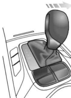
Una vez que se selecciona D, mueva la palanca de cambios hacia la derecha para habilitar el modo deportivo (la marcha que se muestra en la interfaz del paquete de instrumentos cambia a "S"). En el modo Sport, la transmisión cambia más tarde para aprovechar al máximo las reservas de potencia del motor.
