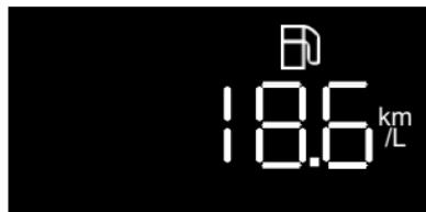
Muestra el consumo de combustible actual cuando el motor está en funcionamiento. Cuando la velocidad del vehículo es inferior a 5 km/h, la unidad de consumo de
