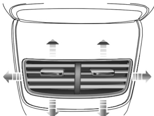
Gire la perilla en sentido horario o antihorario hasta el final para abrir o cerrar la rejilla de ventilación. Dirija el flujo de aire moviendo el mando situado en el centro de las rejillas hacia arriba o hacia abajo, o de un lado a otro.
