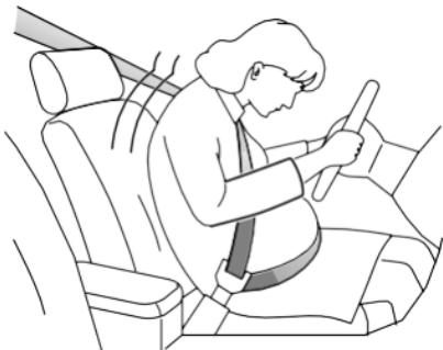
La sección diagonal del cinturón de seguridad debe pasar a través del pecho como de costumbre, la sección del regazo del cinturón debe pasar por debajo del abdomen, baja y ajustada en los huesos de la cadera. Nunca coloque el cinturón sobre o encima del vientre.
