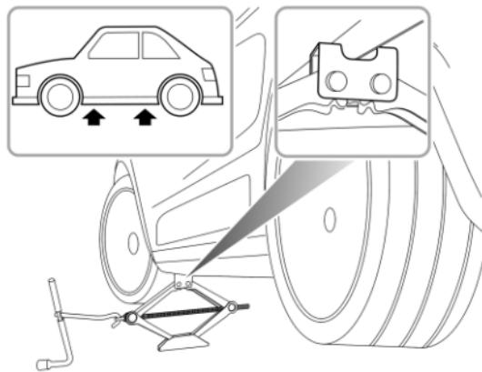
Asegúrese de que la base del gato esté totalmente en contacto con el suelo nivelado.
