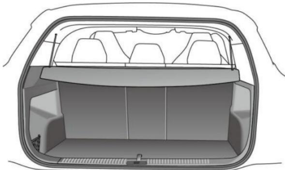
La bandeja cubreequipajes está conectada a los ganchos del portón trasero con cables, al abrir el portón trasero, la bandeja cubreequipajes será levantada.
