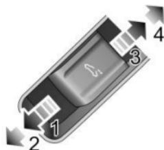
Empuje el interruptor de cristal del techo panorámico hacia atrás hasta la 1<sup>a</sup> posición (3) y manténgalo pulsado, el techo solar será abierto manualmente por deslizamiento.
