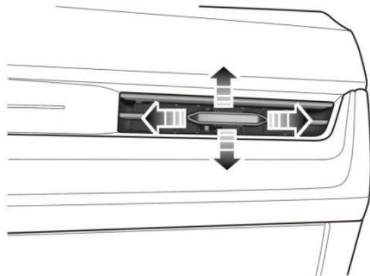
Deslice el botón situado en el centro de las rejillas de ventilación de un lado a otro para abrir o cerrar la rejilla de ventilación. Dirija el aire moviendo el botón hacia arriba y hacia abajo, o de lado a lado.
