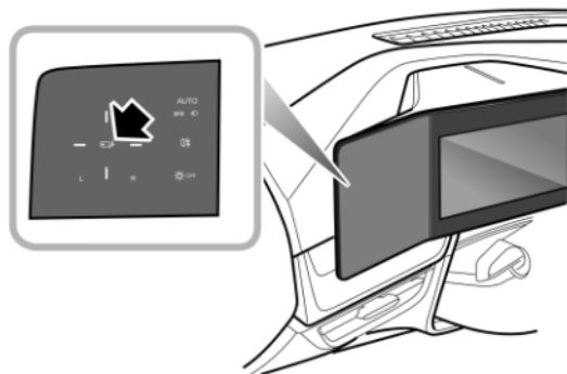
Pulse el interruptor de plegado del retrovisor exterior (flecha), el retrovisor exterior será plegado eléctricamente. Si vuelve a pulsar el interruptor, los retrovisores volverán a su posición original.
