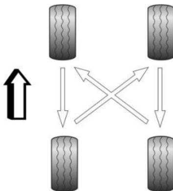
**Nota:** Los neumáticos direccionales (identificados por la flecha en el lateral del neumático) NO pueden ser intercambiados de lado a lado.
