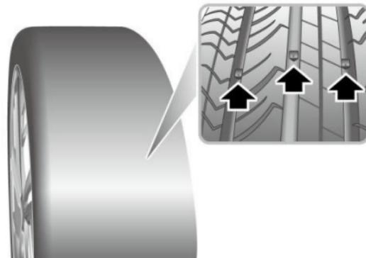
Cuando la banda de rodadura se haya desgastado hasta 1,6 mm o menos, los indicadores saldrán a la superficie del dibujo de la banda de rodadura, produciendo el efecto de una banda continua de goma a lo ancho del neumático.
