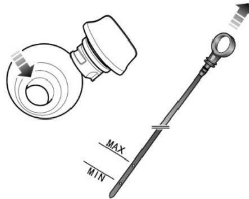
Compruebe semanalmente el nivel de aceite y rellene si es necesario. Lo ideal es que el nivel de aceite sea comprobado con el motor frío y el coche descansando sobre un terreno llano. Si el motor está en marcha y ya se está calentando, espere al menos cinco minutos después de desconectar el interruptor de arranque antes de comprobar el nivel de aceite.
