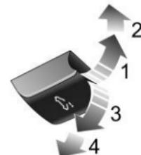
Empuje hacia arriba el interruptor del cristal del techo panorámico hasta la 1<sup>a</sup> posición (1) y manténgalo pulsado, el techo panorámico será abierto manualmente de forma inclinada. El movimiento del techo panorámico puede ser detenido en cualquier momento soltando el interruptor.
