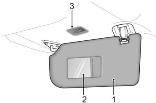
Los parasoles están situados en el techo delante del conductor y del acompañante (1). Los parasoles están equipados con un espejo de cortesía \* (2) y una luz de espejo de cortesía \* (3).
