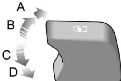
Presione el interruptor de control de la ventanilla (1~4) hacia abajo hasta la posición "I" (Posición C) para bajar la ventanilla, y tire del interruptor hacia arriba hasta la posición "I" (Posición B) para subir la ventanilla. La ventana dejará de moverse en cuanto se suelte el interruptor.
