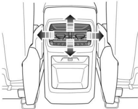
Deslice el botón situado en el centro de las rejillas de ventilación de un lado a otro para abrir o cerrar la rejilla de ventilación. Dirija el aire moviendo el botón hacia arriba y hacia abajo, o de lado a lado.
