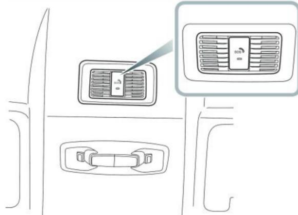
El sistema de llamada de emergencia (eCall) realizará una autocomprobación cuando el interruptor START/STOP esté en posición "ON/RUNNING". El indicador LED de estado del botón SOS se iluminará si no hay fallos en el sistema. El indicador LED de estado estará apagado o permanecerá ON después de parpadear lentamente si se detecta un fallo. El mensaje de fallo correspondiente será visualizado en el cuadro de instrumentos.
