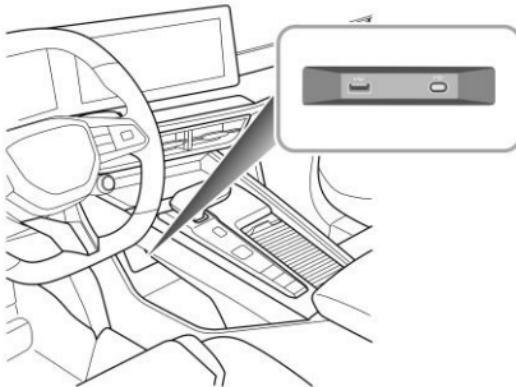
El puerto USB delantero está situado debajo de la parte delantera de la consola central. Cuando el interruptor START/STOP está en la posición ACC/ON/RUNNING, el puerto USB puede suministrar tensión de 5 V como interfaz de alimentación o realizar la función de transmisión de datos.
