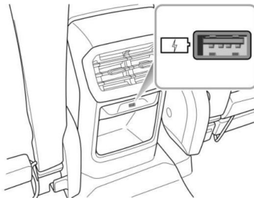
También hay un puerto USB en la parte trasera de la consola central. Cuando el interruptor START/STOP está en la posición ACC/ON/RUNNING, el puerto USB puede suministrar una tensión de 5 V como interfaz de alimentación. Su corriente máxima de funcionamiento es de 3 A.
