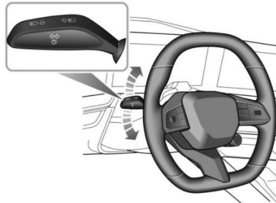
Con el interruptor START/STOP en la posición ON/RUNNING, accione el interruptor de la palanca de luces hacia arriba o hacia abajo para encender las luces intermitentes. El indicador de dirección VERDE correspondiente en el cuadro de instrumentos parpadeará cuando las luces intermitentes estén en funcionamiento.
