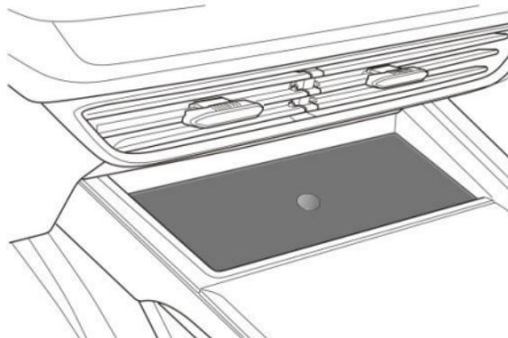
La zona de carga inalámbrica está situada delante de la palanca de cambios; cuando el interruptor de arranque está en la posición RUNNING, la función de carga puede ser utilizada. Coloque el teléfono boca arriba, con la parte trasera pegada a la zona de carga para la carga inalámbrica.
