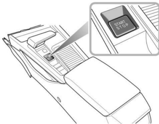
El interruptor START/STOP sin llave está situado en el panel embellecedor superior de la consola central y es un botón de tipo pulsante. Para accionar el sistema, la llave inteligente o la llave Bluetooth deben estar en el automóvil.
