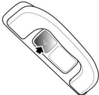
Las luces interiores traseras están situadas en los lados izquierdo y derecho del techo. Pulse el interruptor tal y como indica la flecha para encender las lámparas y vuelva a pulsarlo para apagarlas.
