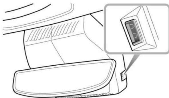
También hay un puerto USB en el retrovisor interior. Cuando el interruptor START/STOP está en la posición ACC/ON/RUNNING, el puerto USB puede suministrar una tensión de 5 V como interfaz de alimentación, y su corriente máxima de funcionamiento es de 2 A.
