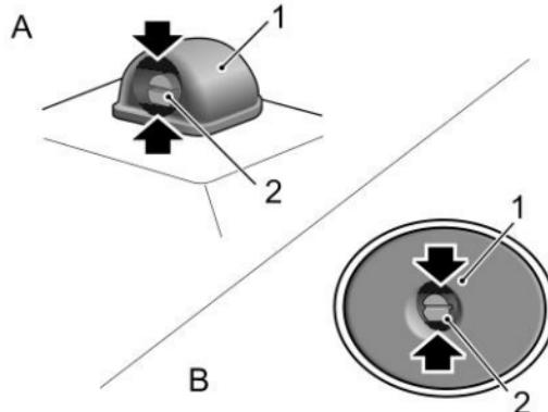
La boquilla del lavaparabrisas (A) está situada en el panel de la rejilla de entrada de aire del A/C del compartimento del motor, y la boquilla del lavaparabrisas trasero (B) está situada en el alerón detrás de la carrocería.
