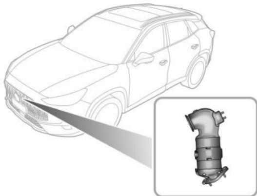
El sistema de escape incorpora un convertidor catalítico, que convierte las emisiones venenosas de escape del motor en gases menos nocivos para el medio ambiente.
