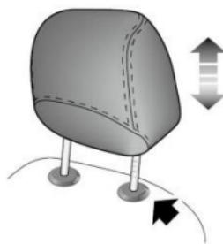
Al ajustar un apoyacabezas de la posición baja a la posición alta, tire del apoyacabezas directamente hacia arriba, y presíñelo suavemente hacia abajo después de que alcance la altura deseada para asegurarse de que está bloqueado
