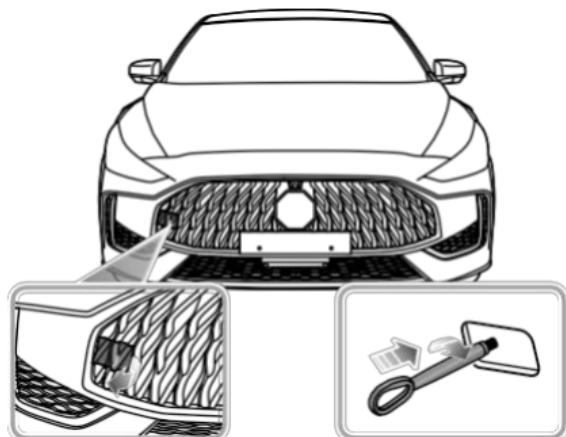
Su vehículo está equipado con una argolla de remolque (situada en la parte delantera del vehículo), que se utiliza para colocar el gancho de remolque en la caja de herramientas. La caja de herramientas se coloca debajo de la alfombra de la cajuela.
