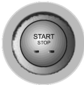
El interruptor de START/STOP sin llave está situado en el tablero de instrumentos, a la derecha de la columna de dirección, y es un interruptor de tipo pulsador. Para accionar el sistema, la llave inteligente debe estar en el vehículo.
