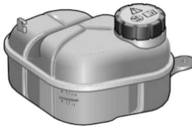
El sistema de refrigeración debe comprobarse semanalmente cuando el sistema de refrigeración está frío y con el vehículo apoyado en un terreno llano. Si el nivel de refrigerante está por debajo de la marca "MIN",
